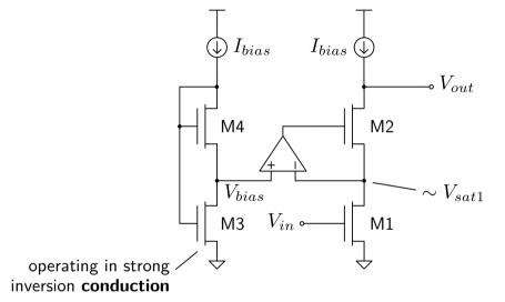
$\begin{cases} I_{bias} = \beta_3 \left( V_{GB3,4} - V_{TH} + \frac{n}{2} V_{bias} \right) V_{bias} \\ I_{bias} = \frac{\beta_4}{2n} \left( V_{GB3,4} - V_{TH} - n V_{bias} \right)^2 \end{cases}$
